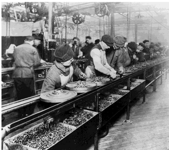
1. ábra. Futószalagos gyártósor a Ford gyárban (1913.) [1.]
