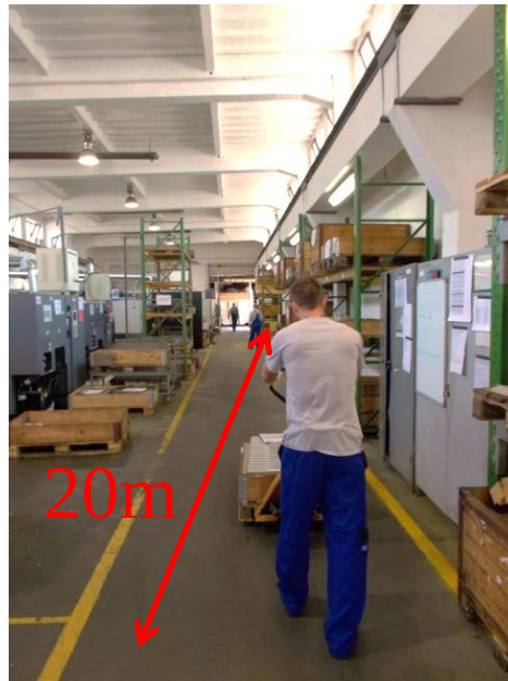
8. ábra. Túl nagy távolság okozta anyagmozgatási veszteség [5.]
